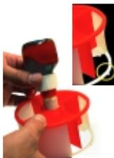
Stecken Sie dann die 50 ml Botenstoffflasche in das rot-weiße Botenstoffrohr. Setzen Sie das Botenstoffrohr (mit Öffnung/Kerben zu Ihnen gerichtet) in die Aufnahmeplatte im Gerät, indem Sie es zuerst nach hinten schieben und dann durch leichten Druck auf den vorderen, freien weißen «Ring mit Nase» (siehe kleines Foto) in die Gerätehalterung einrasten lassen.
