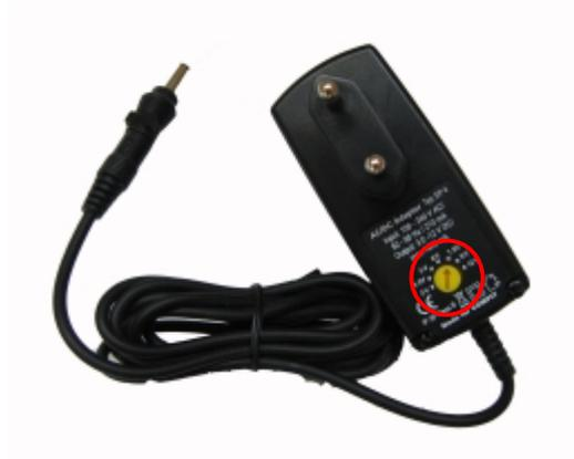
Einstellen des Ventilators mit Einstellschlüssel oder Schraubenzieher auf der gelben Drehscheibe, unten am Netzteil, durch Drehen verändern.
