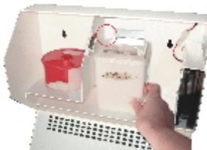
3. Die Aiomex®-Neutralisationseinheit (B) gegenüber des Ventilators an die Innenwand in das Gerät stellen.
